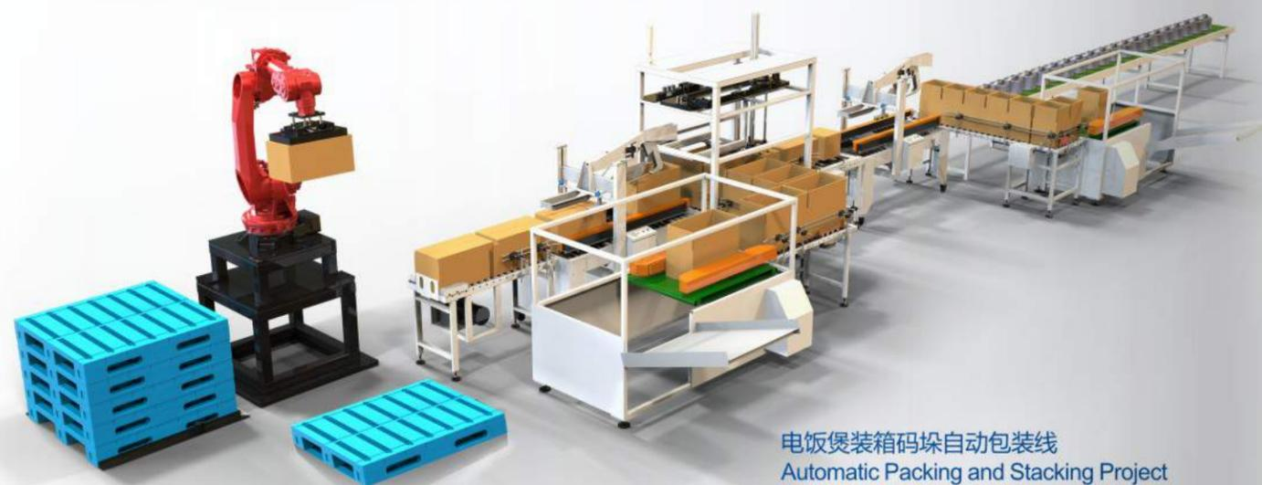
电饭煲装箱码垛自动包装线
