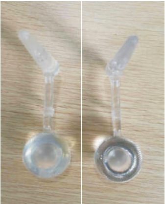
LED透镜COC (普通三机一体) 黄变
